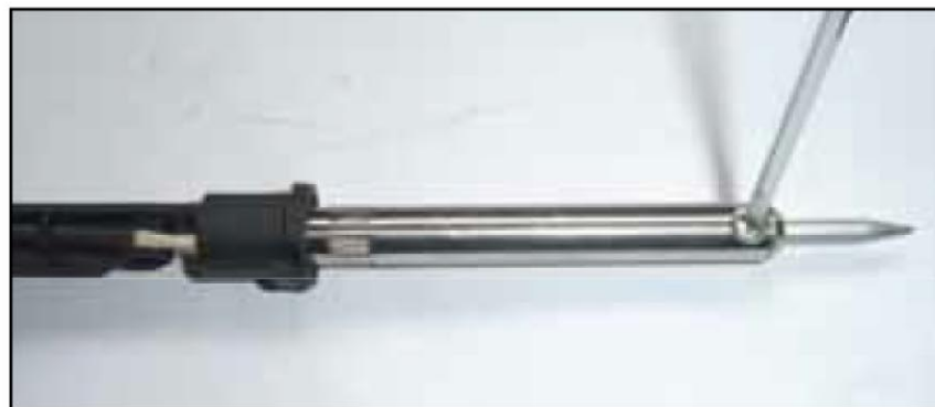
2.用十字螺丝刀拧下烙铁头固定螺栓(两个)
