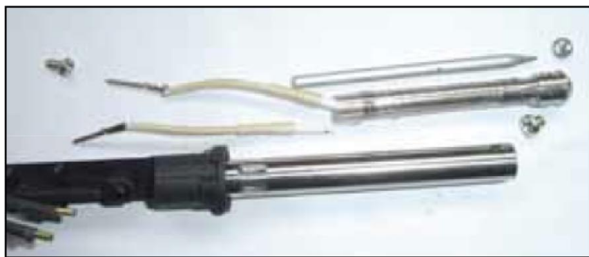
3.取下烙铁头和损坏的发热芯
