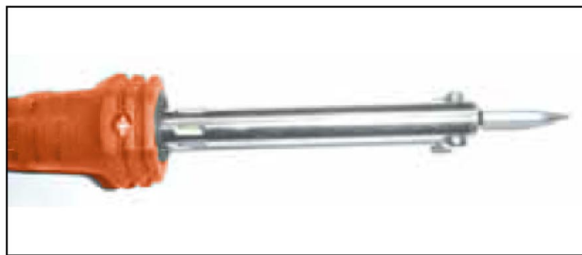
4.换上新的发热芯，重新装回烙铁和手柄，上系螺栓
